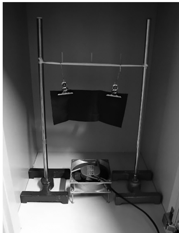
写真5 汚染試験布とFANの設置状況
